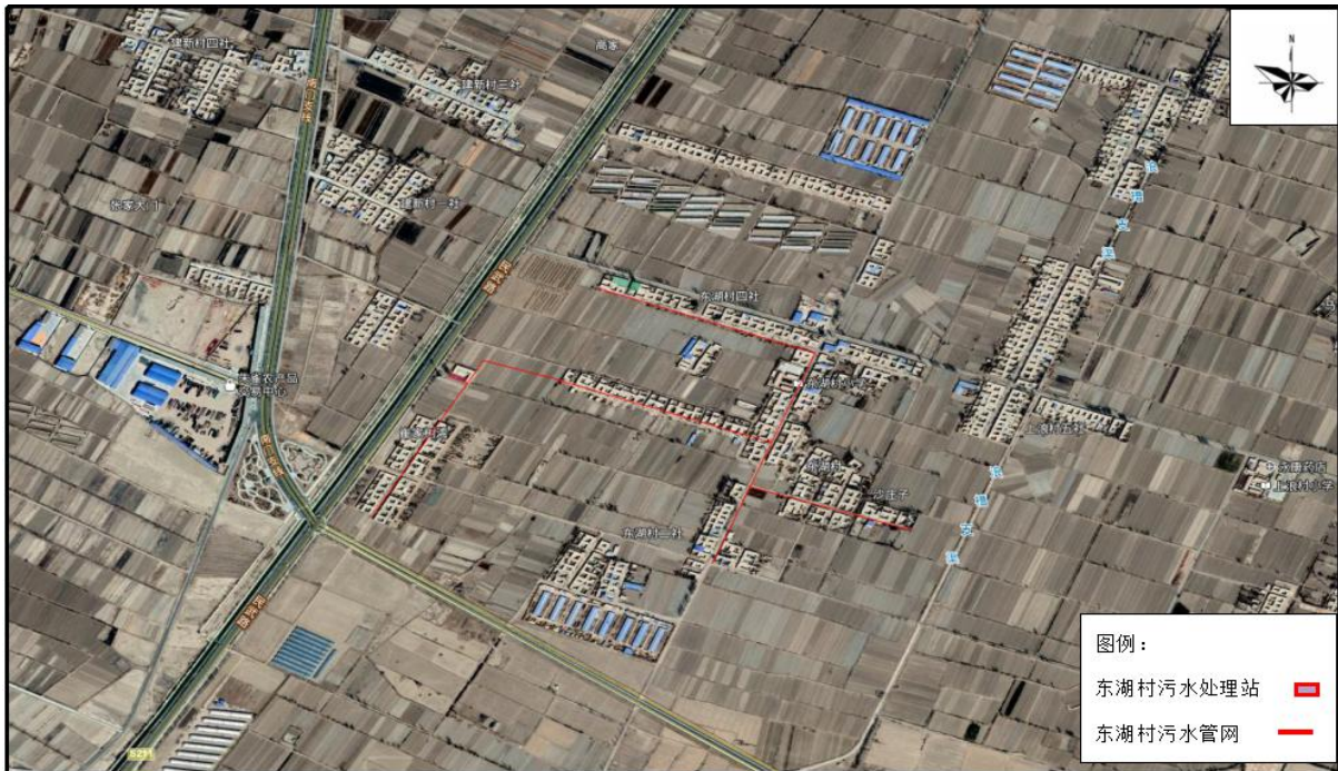
图 3 苏武镇东湖村污水管网平面布置
