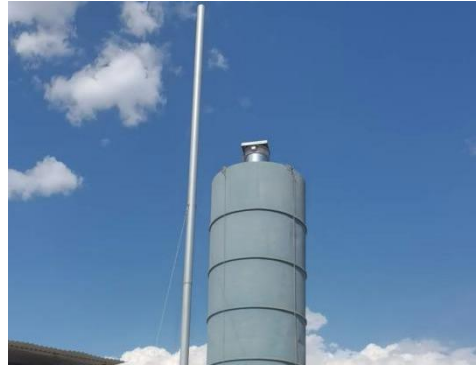
水泥筒仓滤芯除尘器
